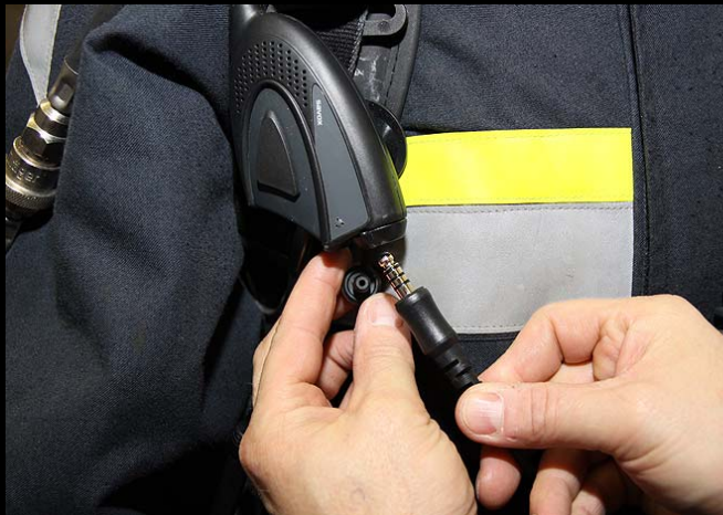
10. Funkverbindungsstecker in den Adapter
